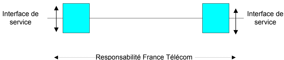
Figure 2 : Liaison point à point
